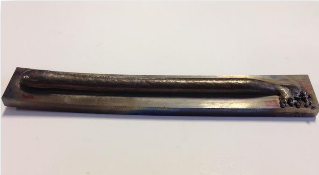
经过六层沉积后，制造零件中出现肉眼可见的变形
