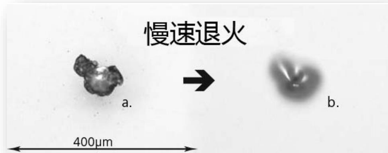
慢速退火工艺修复(a)处损伤, (b)为修复点
